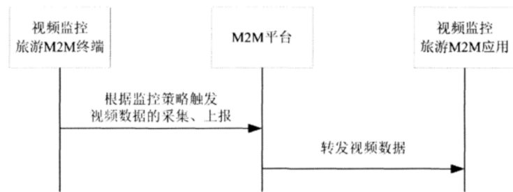
图13 旅游M2M终端发起的视频监控业务流程
