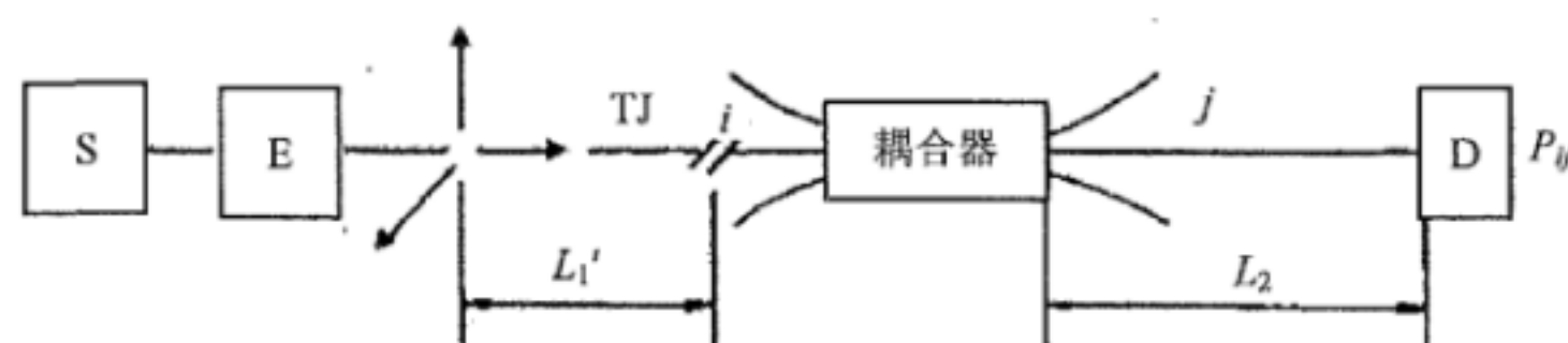
图4 尾纤型耦合器插入损耗测试原理
