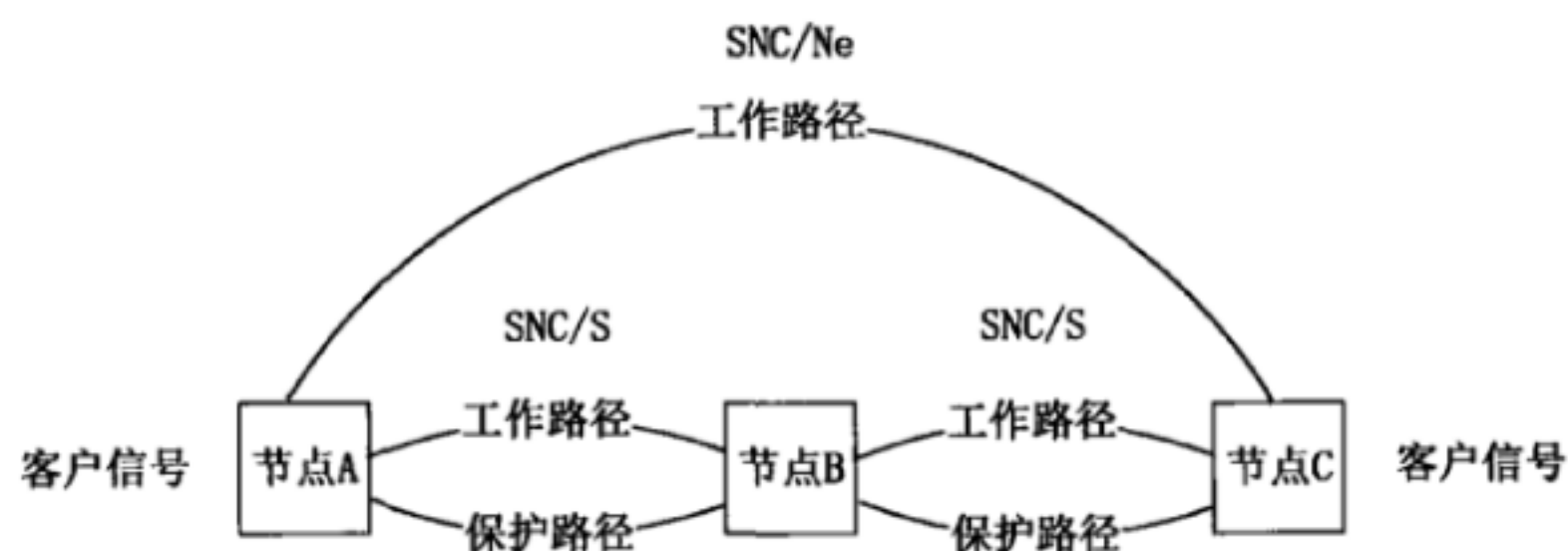
图 5 ODUk SNC/S 和 ODUk SNC/Ne 保护嵌套
