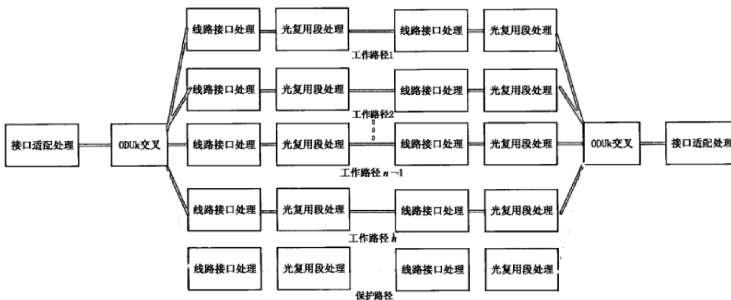
图3 ODUk 1:n SNC 保护示意
