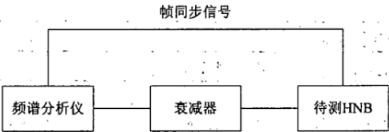
图12 杂散辐射测试装置连接示意
