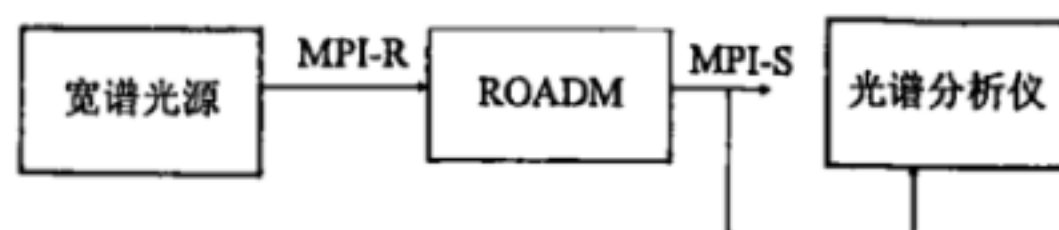
图39 穿通通道隔离度的测试配置
