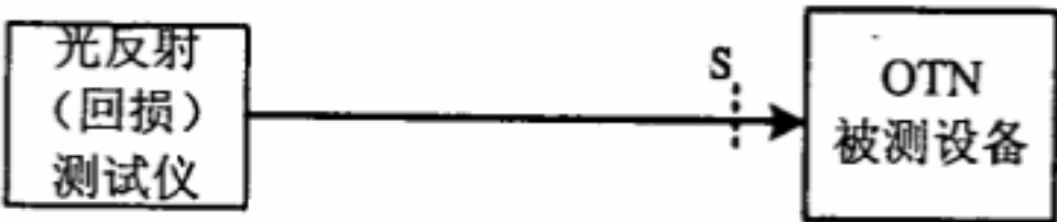
图 16 反射系数测试配置
