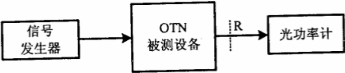
图 11 平均发送光功率测试配置
