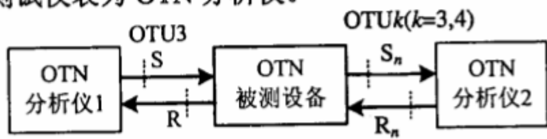
图 36 OTU3 业务映射测试配置
