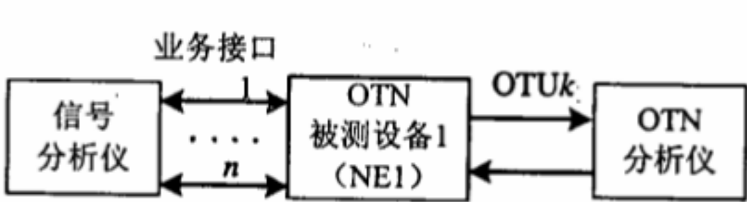
图 41 ODU k 复用测试配置
