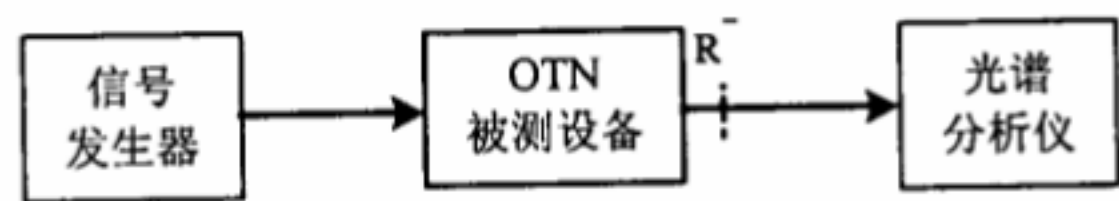
图 13 激光器工作波长测试配置
