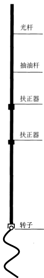
图 2 带特殊工具杆柱结构图
