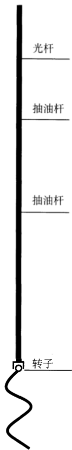
图 1 基本杆柱结构图
