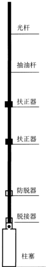
图 2 带特殊工具抽油杆柱结构图
