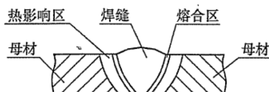
图 2.0.6 焊接接头示意图
