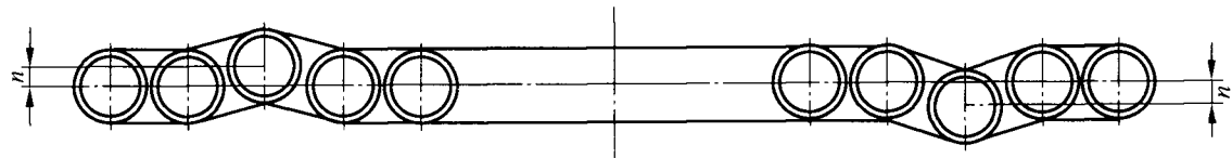
图 5.2.3-10 盘形管相邻两根管子的平面错位
