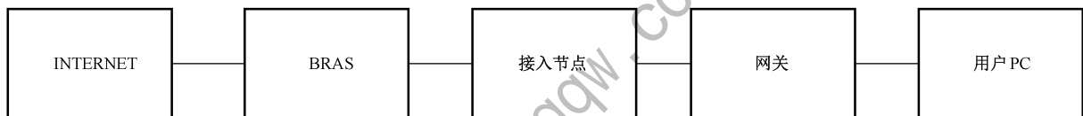
图 1 设备配置安全性测试配置
