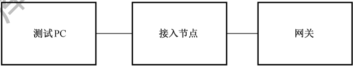
图 3 防端口扫描测试配置
