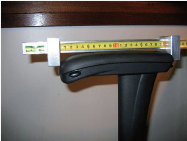
图 59 测径规(卡钳)测量扶手长度
