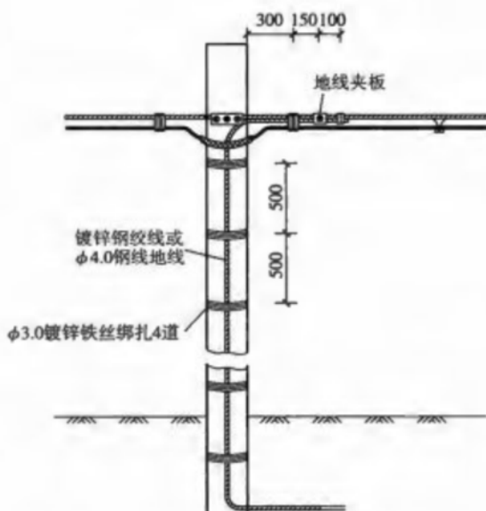
图 5.5.19-3 吊线直接入地式地线安装图(mm)
