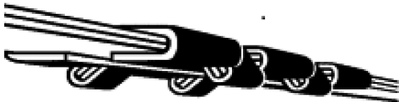
图 C.1 向下剪切锁紧方式
