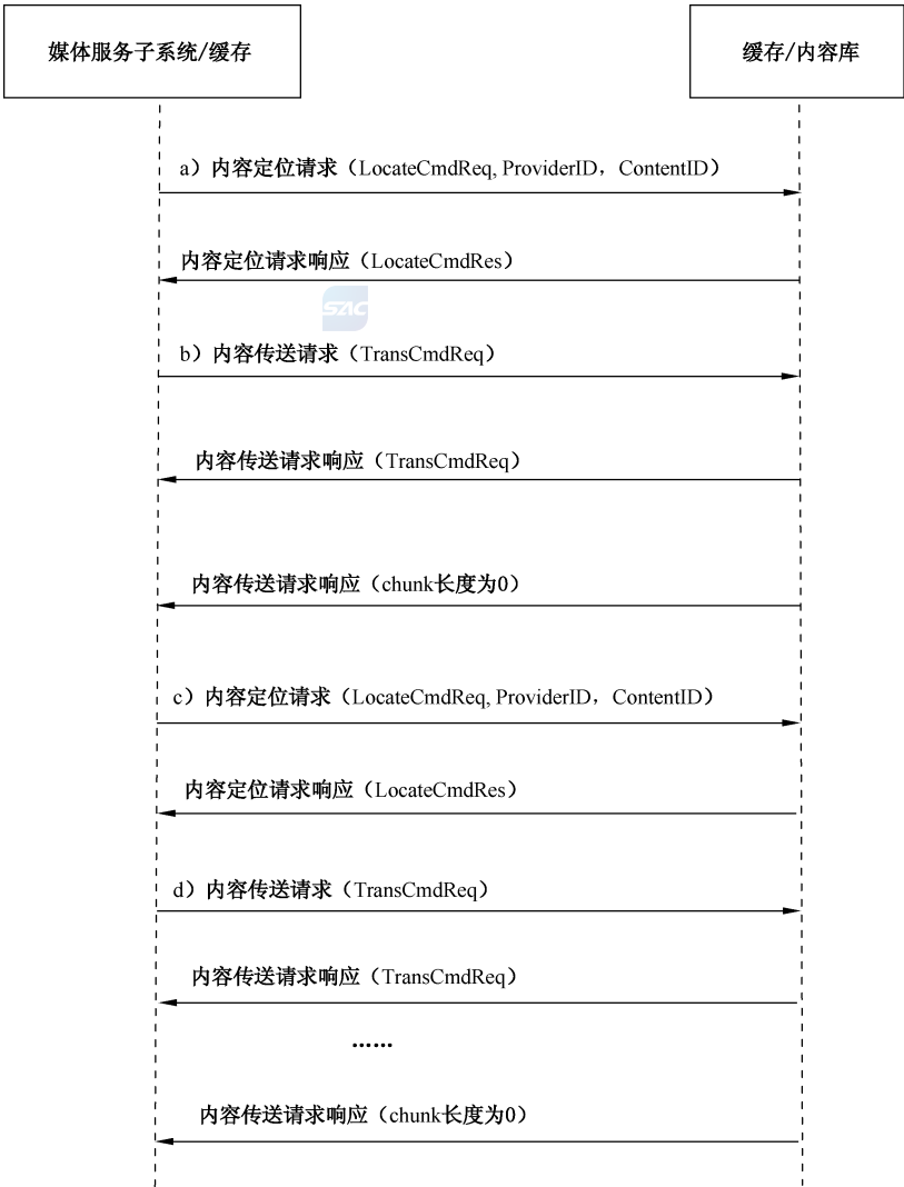
图 11 PC 终端直播(FLV)服务接口流程示意图
