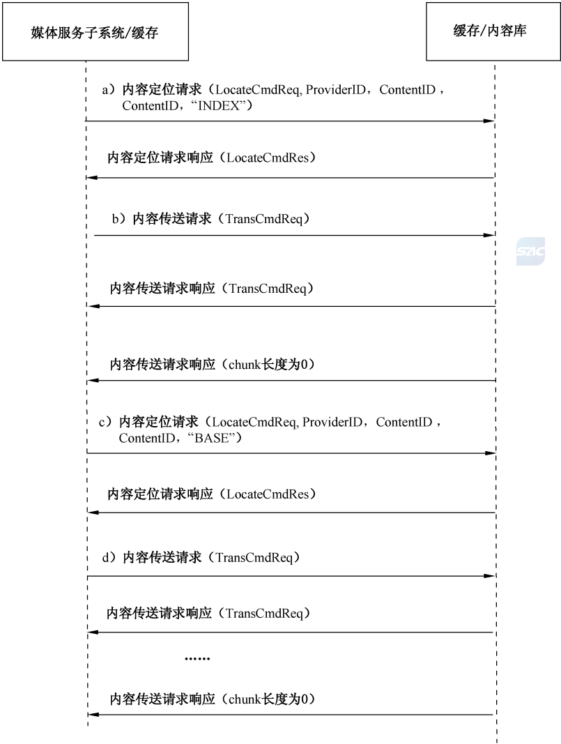
图 15 移动智能终端直播 (ISMA) 服务接口流程示意图
