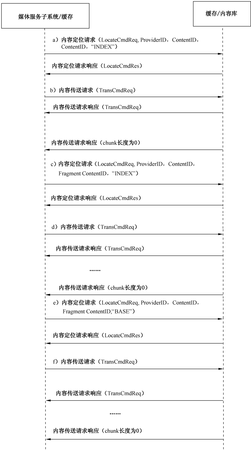
图 6 时移服务基本速率播放接口流程示意图
