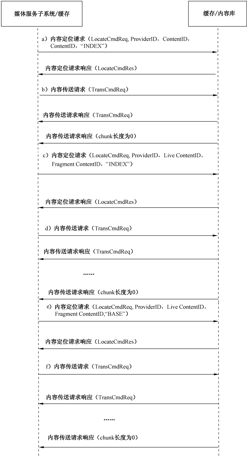
图 8 机顶盒加电视机终端回看基本速率接口流程示意图
