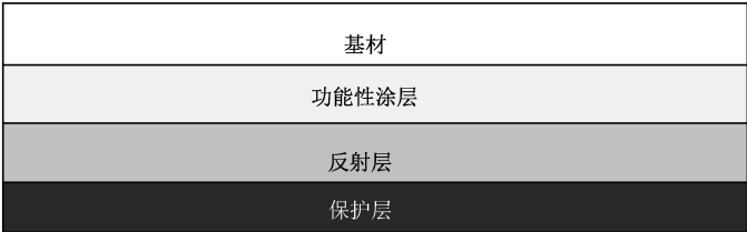
图 A.1 冷烫印全息防伪箔的结构示意图
