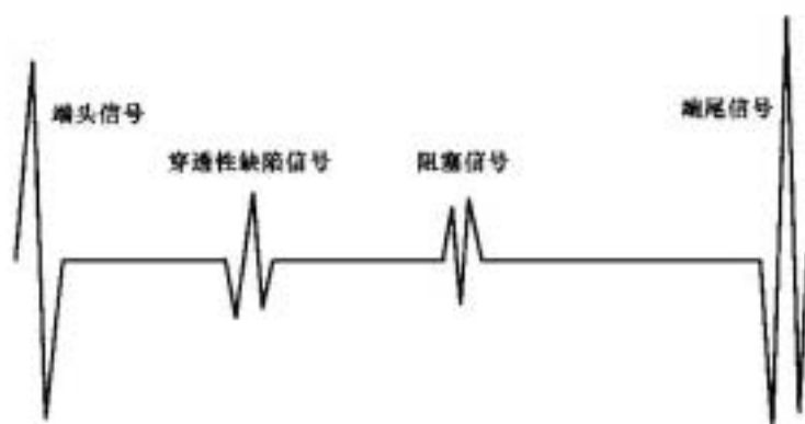
图 1 声脉冲检测法原理示意
