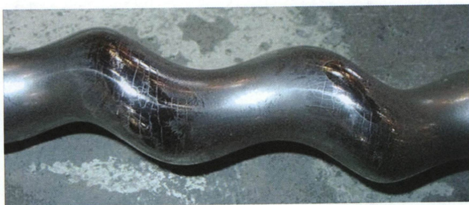
图 K.3 裂纹或热裂转子
