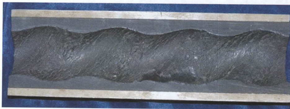
图 K.6 烧损或过热的定子
