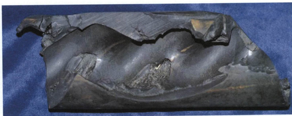
图 K.8 脱胶的定子
