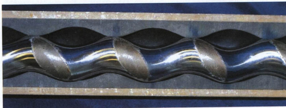
图 K.2 磨损的转子
