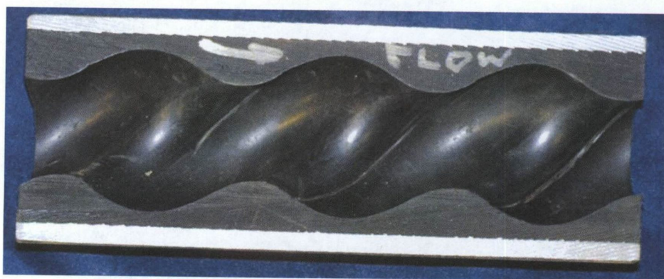
图 K.7 冲蚀或高压冲刷的定子
