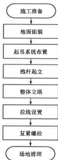
图 6.3.1 铁塔整体组立施工工艺流程图
