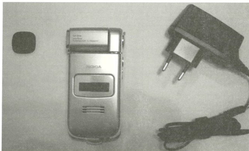
图 E.1 带有电池充电器和摄像头盖子的 A 型手机
