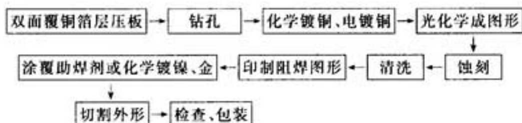
(b) 双面板典型生产工艺流程
