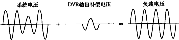
图 A.1 动态电压恢复器工作原理示意图
